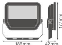
Scheda tecnica Ledvance Proiettore LED GEN 3 Bianca 30W 3600lm 100D - 865 Luce del Giorno | IP65 - Simmetrico
