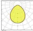
Scheda tecnica Ledvance Proiettore LED GEN 3 Bianca 10W 1200lm 100D - 865 Luce del Giorno | IP65 - Simmetrico
